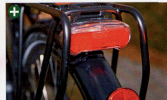
+++ Im Detail stimmig: Das LED-Rücklicht mit Standlicht sitzt gut geschützt zwischen den Trägerstreben.
